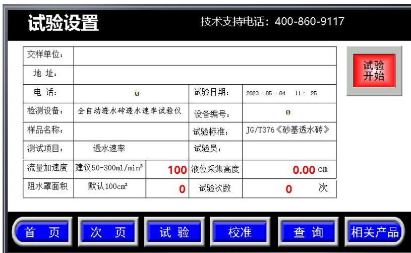
点击各个需要设定的位置即可弹出输入键盘。液位采集高度传感器可以随意设置。应经过一次模拟试验后，请观察阻水罩上的真实高度来确认
