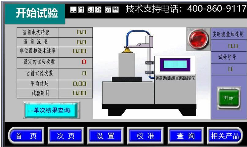
按上述要求做好后点击“开始”键，设备按照流量加速度的数值运行，并显示流量，流速，当阻水罩内的液位到达感应液面后，设备发出蜂鸣声，并关闭设备运行，此时记录公式所需的各项数值，自动计算结果。
