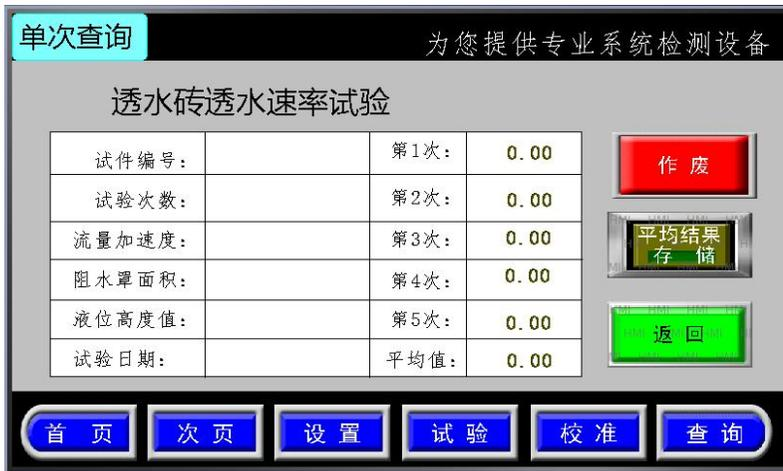
7. 查看单个试件的试验结果。如果在某一次试验过程中出现失误的话可立即删除该次试验。其他试验不影响最终试验结果。完全试验结束后点击“平均结果存储”
