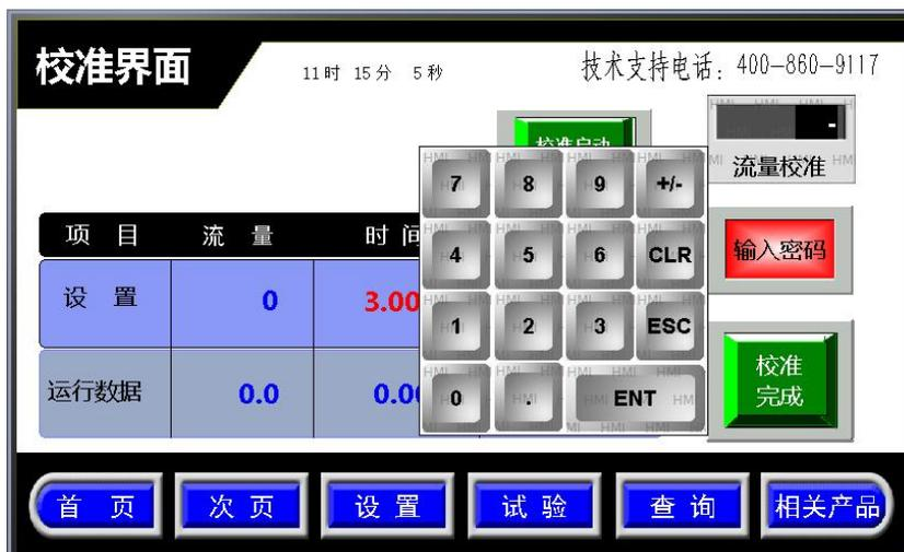
在“流量校准”修正流量的误差值。“+/-”键可切换正负值。按“ENT”确认。关闭密码，按“校准完成”。
